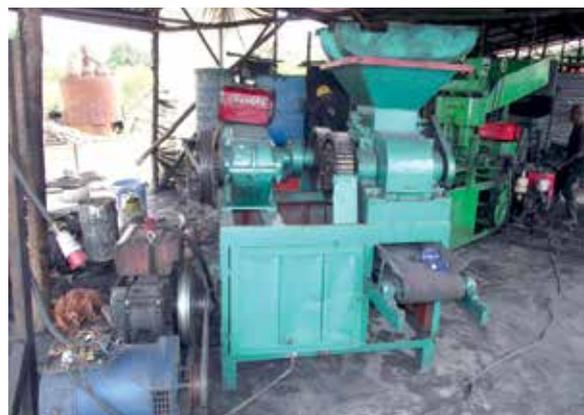
Machine fabriquée en Ouganda, qui produit plus d'une tonne de charbon vert par heure.
