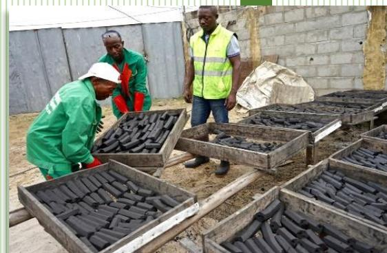
Le « charbon vert » ou « biocharbon » est un combustible fabriqué à base de résidus organiques (coques de noix de coco, résidus de tiges, rafles de maïs, sciure, peaux de bananes, etc.). Il est peu connu de la population et pourtant, il constitue une source d'énergie renouvelable et une alternative au bois énergie. Il remplace avantageusement le charbon de bois, dont la fabrication entraîne la surexploitation des ressources forestières et des zones de mangroves.
